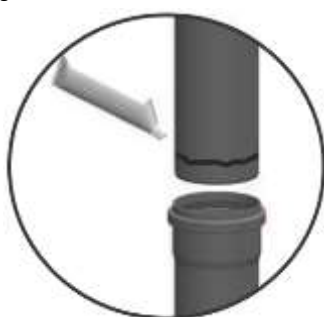
Abb. 3, untere Steckenden der abgasführenden Rohre einfetten
