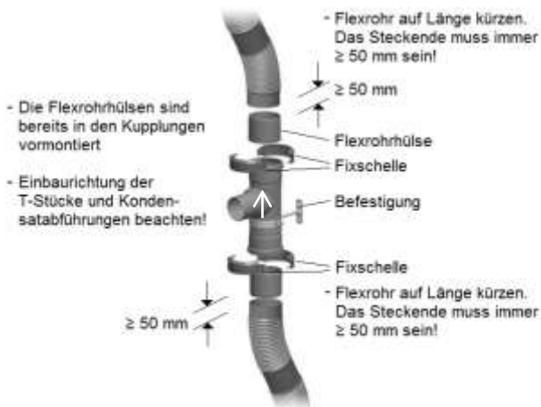
Abb. 10, Beispiel T-Stück mit Fixschelle sichern
