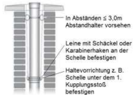
Abb. 11, Rohrelemente im Schacht ablassen
